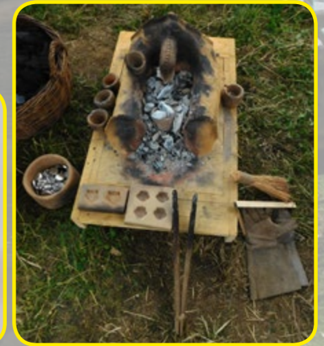
Rekonstrukcija talilne peči z lončnimi kalupi in talilnimi lončki, kositrom, lesenimi prijemalkami in zaščitnimi rokavicami.
