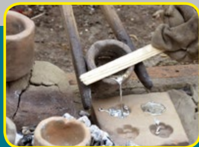
Ulivanje kositrnega predmeta z železnodobnim motivom iz Kleinkleina (avstrijska Štajerska).
